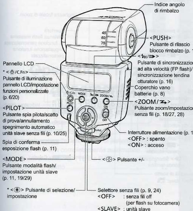
I pulsanti contrassegnati con un asterisco sono dotati di un timer che mantiene attiva la funzione del pulsante per 8 secondi (⊘8) dopo il rilascio del pulsante. L'illuminazione <C.Fn> dura per 12 secondi.
