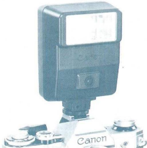
un obiettivo Canon FL, che non consente la misurazione della luce a tutta apertura, la fotografia col flash automatico può essere eseguita regolando manualmente sull'obiettivo il prescritto f/stop. In entrambi i casi, la velocità di otturazione viene regolata automaticamente sul valore di sincronizzazione X di 1/60 secondo.
