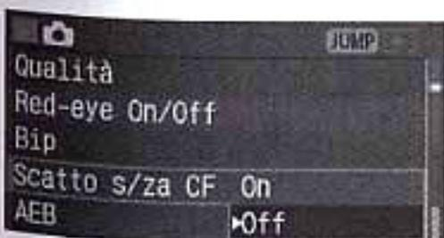
Se la funzione è stata impostata su **[Off]** e si preme il pulsante di scatto quando nella fotocamera non è inserita alcuna scheda CF, nel mirino e nel pannello LCD viene visualizzato "no CF".
