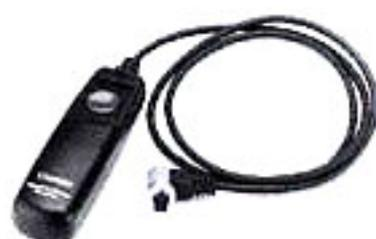
Comando a distanza da utilizzare per evitare vibrazioni della fotocamera durante l'uso di teleobiettivi, obiettivi macro ed esposizioni in posa. È dotato di un cavo di 80 cm. L'interruttore produce lo stesso effetto di quello ottenuto premendo il pulsante dell'otturatore a metà o completamente. È anche disponibile un blocco dell'apertura dell'otturatore. Il connettore di collegamento della fotocamera è provvisto di dispositivo di bloccaggio rapido.
