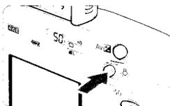
Per illuminare il pannello LCD, premere il pulsante <☼>. Per disattivare l'illuminazione, premere nuovamente questo pulsante. L'illuminazione viene disattivata quando si preme il pulsante dell'otturatore a metà.
