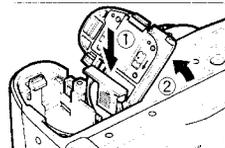
Per la batteria della data e dell'ora, utilizzare una batteria al litio CR2016.
