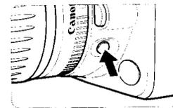
Premere il pulsante di previsualizzazione della profondità di campo per mantenere l'impostazione di apertura corrente. Il diaframma nell'obiettivo viene impostato sull'apertura corrente; in tal modo, è possibile controllare la profondità di campo (area di messa a fuoco accettabile) attraverso il mirino.
