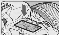
Ogni volta che si preme il pulsante <☀>, l'illuminazione del pannello LCD viene attivata o disattivata (☉6). Durante l'esposizione posa, se si preme a fondo il pulsante di scatto, l'illuminazione del pannello LCD viene disattivata.
